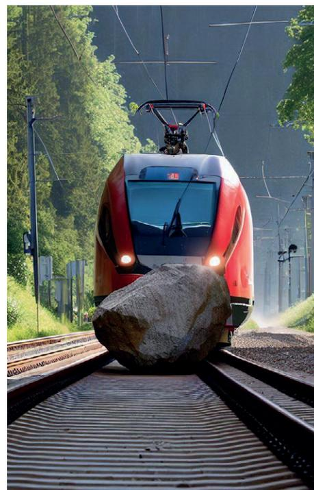
erkennen. Sobald einer der Sensoren ein Hindernis erkennt, generiert das System eine Warnmeldung, die zusammen mit einem Bild des Hindernisses an die entsprechende Stelle bei der ÖBB übermittelt wird.
